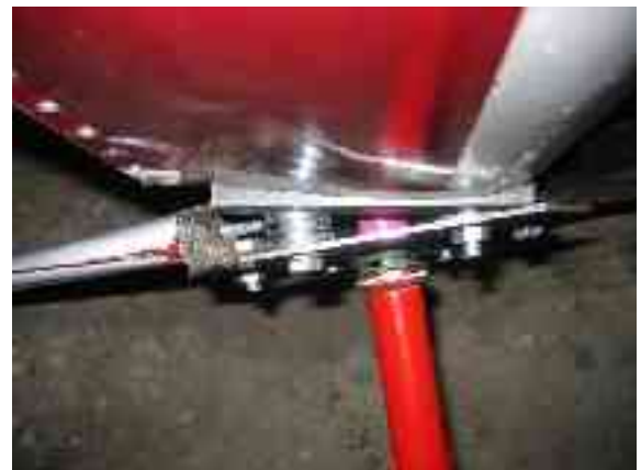
On peut faire varier l'angle d'incidence grâce aux rondelles.
